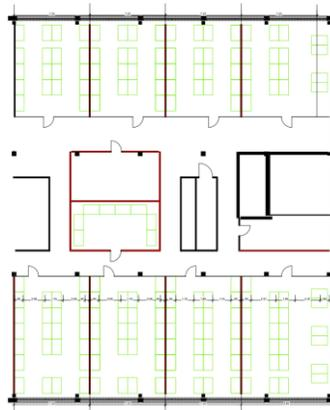
Das 6.97 m bis 7.20 m breite Säulengitter erlaubt eine für Labor- und Reinnräume optimierte Flächennutzung. Die Innenräume sind für Druckluft, Technik- und Reinwasseranlagen Typ I bis III konzipiert (keine permanente AP).
